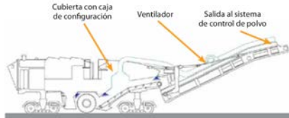
Figura 1: Máquina fresadora de pavimento asfáltico con controles de polvo de sílice (ilustración del NIOSH).
